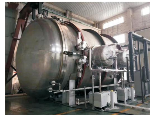
Ultra High Vacuum System 超真空系统
